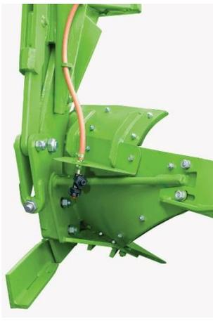
Os bicos de aspersão do tipo leque, são instalados imediatamente atrás de cada conjunto de aivecas em um suporte específico, lançando a calda diretamente sobre o fundo do sulco aberto pela aiveca, criando uma barreira química em toda a extensão trabalhada pelo arado. A aiveca seguinte cobre esse sulco de forma uniforme.
