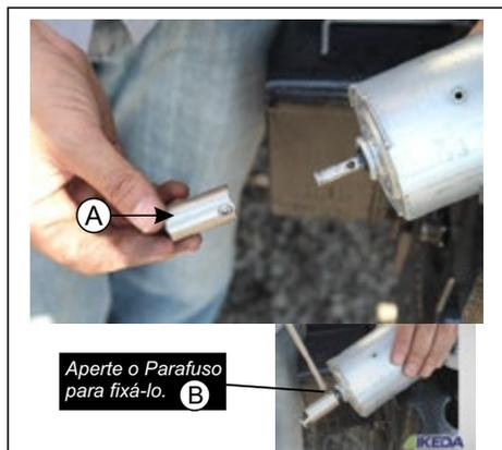
**ETAPA 15** - Encaixe o Cubo Auxiliar (A) no eixo do motor, aperte o Parafuso Inferior para fixá-lo. Utilize a Chave Allen 1/8" (F).
