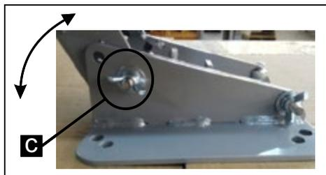
Se necessário executar um pequeno ajuste para manter a Semeadora Adubadora nivelada, tire a porca borboleta indicado acima (na lateral da base), e execute o ajuste. Ao finalizar, coloque parafuso e a porca borboleta.
