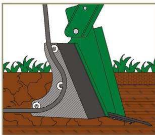
O encaminhamento da mangueira no interior da haste é garantido por roldanas guias de nylon technil, instaladas entre as duas asas laterais. A emenda da mangueira é feita no próprio implemento, com uma rápida interrupção do movimento do trator para colocação do niple, que também passa pelo interior da haste.
