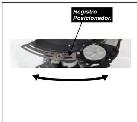
**ETAPA 22** - Com a MS ligada e a Alavanca de Dosagem travada (regulada anteriormente), observe o leque de distribuição dos insumos, e então ajuste o **Registro Posicionador** e a velocidade no **Painel de Controle** de forma que o leque de distribuição fique o mais uniforme e centralizado possível - *veja exemplo nos desenhos na página seguinte, Figs. 1 e 2).*
