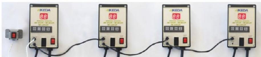
Ligue o interruptor do CABO INTERRUPTOR e automaticamente no visor de cada Controlador aparecerá a configuração individual que foi realizada na 1ª Etapa.
