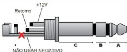
**Passo 2** – Ligue os dois fios internos, nos contatos do interruptor. Use um interruptor que mantenha seus terminais protegidos de contatos acidentais, que pode ser um do tipo “pêra”.
