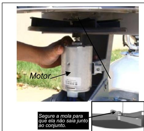
**ETAPA 12** - Retire o Suporte do motor (b) utilizando a chave Allen M4" (E).
