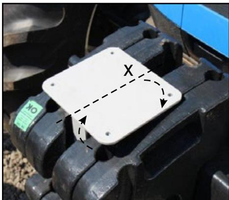
**ETAPA 02** - Nivele em (x) a Contra-Chapa "T" (02), posicionando-a de forma que a coluna T se apoie firmemente nas laterais dos contrapesos e que pelo menos um prisioneiro de sua fixação, transpasse a coluna. Marque esse ponto e com auxílio de uma furadeira, execute um furo para ser transpassado por esse prisioneiro. Isso garantará sua fixação bem firme.
