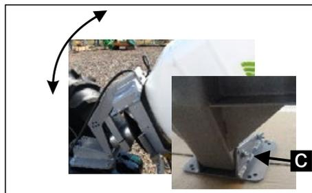
Para executar a limpeza do tanque, retire a porca borboleta e parafuso, e tombe cuidadosamente o tanque, e então recolha as sobras de grãos, para reaproveitá-las. Se possível retire a calha separadora dentro do tanque.
