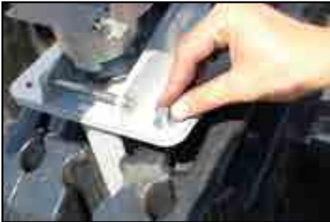
**ETAPA 05** - Fije el MS utilizando cuatro Tornillos Hex. 5/16"x 3/4" (C) seguidos de cuatro Arandelas 5/16" (D).
