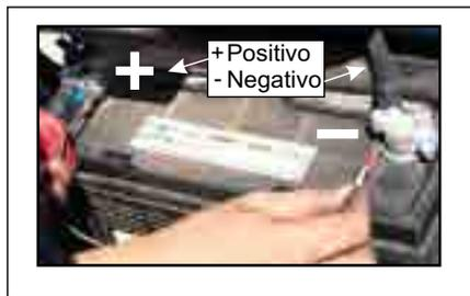
**CUIDADO** : Algunos tractores y pulverizadores autopropulsados trabajan con 24 VCC. Asegúrese de ello y conecte los cables directamente
