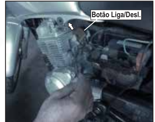
ETAPA 04 - Insira o Botão Liga/Desl. (Extremidade 2) por baixo do tanque, seguindo o cabo de partida da motocicleta.
