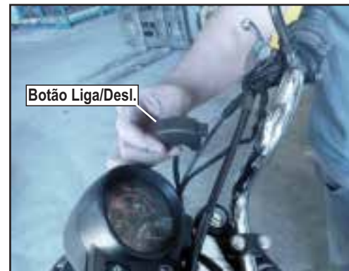
O Botão Liga/Desl. do Chicote deve sair no painel da motocicleta, como mostrado acima.
