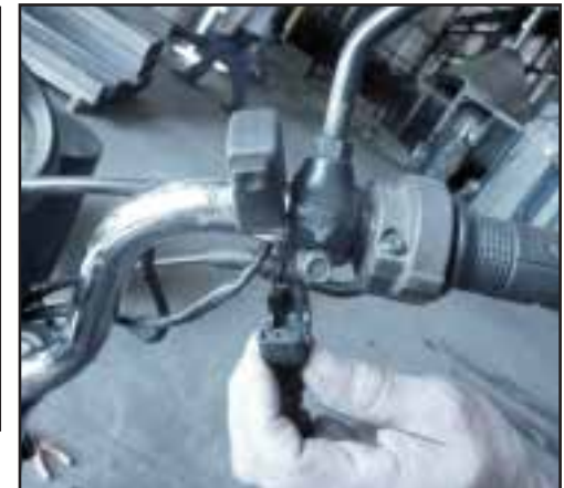
ETAPA 05 - Escolha o lado do guidon de sua preferência e então prenda o Botão Liga /Desl. no guidon da motocicleta, encaixando conforme mostrado acima.
