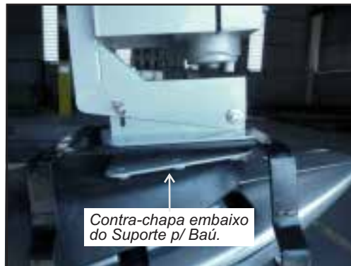
Veja na imagem acima, Contra-Chapa posicionada embaixo do Suporte para Baú.
