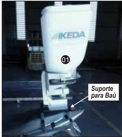
ETAPA 01 - Para instalar a Moto Semeadora MS40 01 , posicione-a sobre o Suporte para Baú instalado, na posição indicada acima.
