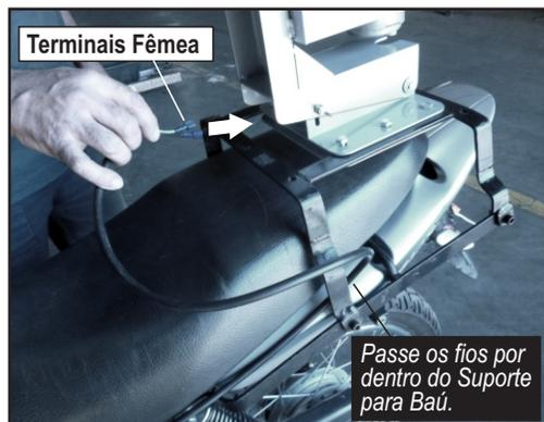
**ETAPA 06** - Passe os Terminais Fêmea (Extremidade 3) do Chicote por dentro da base da Moto-Semeadora MS40, passando o fio por dentro do Suporte para Baú (para o fio não ficar pendente).
