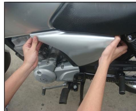
**ETAPA 07** - Retire a Carenagem onde está a bateria da motocicleta. **Obs.:** Em alguns modelos de motocicleta, a carenagem é apenas encaixada, em outros é parafusada. (Siga as instruções do manual da motocicleta).
