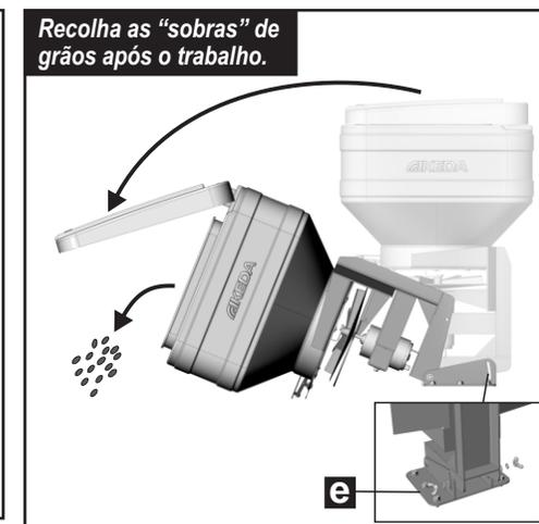
Para executar a limpeza do Tanque, retire completamente as porcas-borboleta indicadas **e**, e tombe cuidadosamente o tanque, e então recolha as sobras de grãos, para reaproveitá-las.
