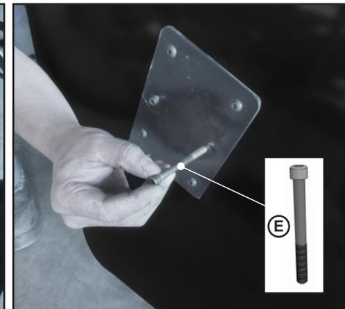
**ETAPA 12** - Coloque dois Parafusos Allen 1/4" x 2 1/2" (E) para fixar o Abridor de Linha.
