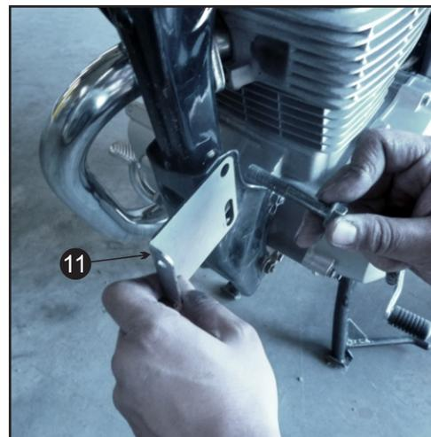
**ETAPA 14** - Acople a Chapa de Fixação 11 do abridor de linha na posição indicada acima.
