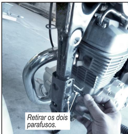
**ETAPA 13** - Para instalar o Abridor de Linha Inferior, primeiro retire os parafusos que prendem a barra de junção do chassi da motocicleta.
