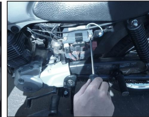
Após fixar os Conectores Anel junto ao cabeamento da motocicleta, aperte os parafusos.
