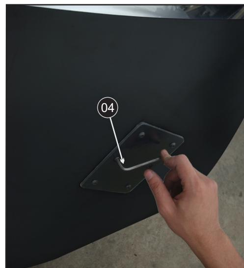
Utilize a Chave Allen 5/32" (04) para apertar os parafusos e fixar a chapa de polietileno.
