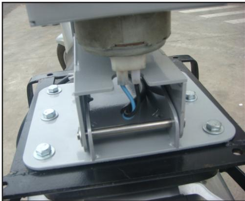
**ETAPA 10** - Conecte então os terminais (Extremidade 3) na parte inferior do motor da Moto-Semeadora, como mostrado acima.
