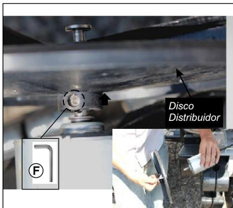
**ETAPA 14 - Afrouxe (não retire) - o Parafuso inferior do Fixador para retirar o Disco Distribuidor e separe-o do motor, utilize a Chave Allen 1/8" (F).**
