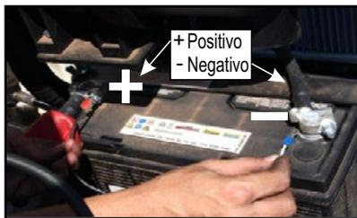
**ETAPA 08 - LIGAÇÃO DO CABO DE FORÇA** - Encaminhar o cabo de força (05) até a bateria do veículo e conectar somente o fio negativo do mesmo (olhal azul) ao polo negativo da bateria.
