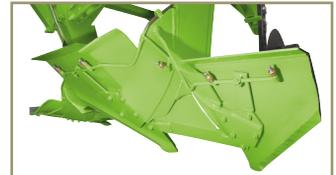
Detalle de la cuchilla con conjunto de boquillas pulverizadoras.
