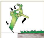
El vástago se arma automáticamente con solo levantar el implemento.
