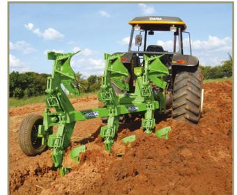
Los sistemas de preparación de suelo más utilizados en el mundo adoptan los ARADOS VERTEDERAS. Son los únicos implementos que descompactan integralmente el suelo en la profundidad deseada y, simultáneamente, incorporan con perfección los residuos de la cultura anterior.
