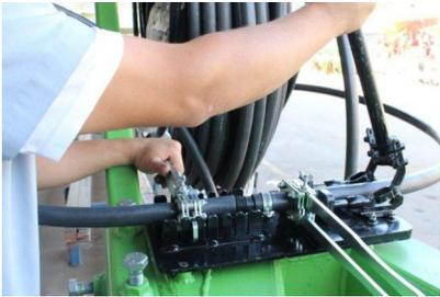
7) Acione a alavanca da mesa, mudando sucessivamente o rasgo onde se encaixa o alicate.
