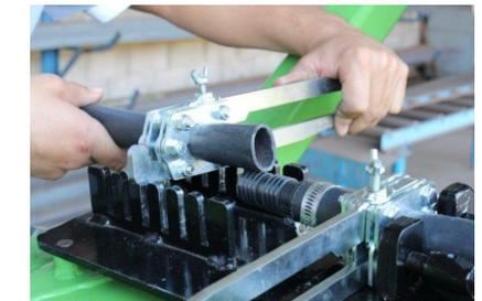
6) Posicione os dois alicates na mesa conforme a foto ao lado. O alicate com a emenda montada deve ficar travado no suporte do torpedão e o outro alicate, nos rasgos da mesa.
