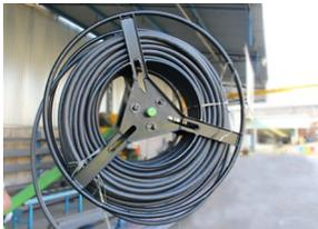
Após a inserção do rolo de mangueira, reposicione os 3 pinos argolas, para retenção do aro externo do carretel.
