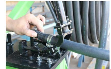
4) Retirando o torpedão da mesa e introduza a mangueira com a emenda montada, por baixo da alavanca de montagem.
