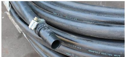
10) A mangueira deve ir para o campo com a emenda montada em uma das extremidades.
